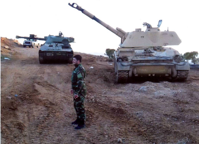
Un obusier 2S1 (à gauche) et 2S3 (à droite) assurent l'appui de feu direct et indirect à l'entrée d'une localité syrienne.
