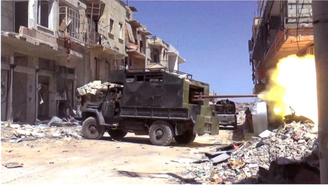
Un camion russe a reçu des plaques de blindage et emporte, sur son pont arrière, un canon de DCA de 57 mm. Ce type d'armes improvisées ou modifiées est visible en grand nombre en Syrie.
