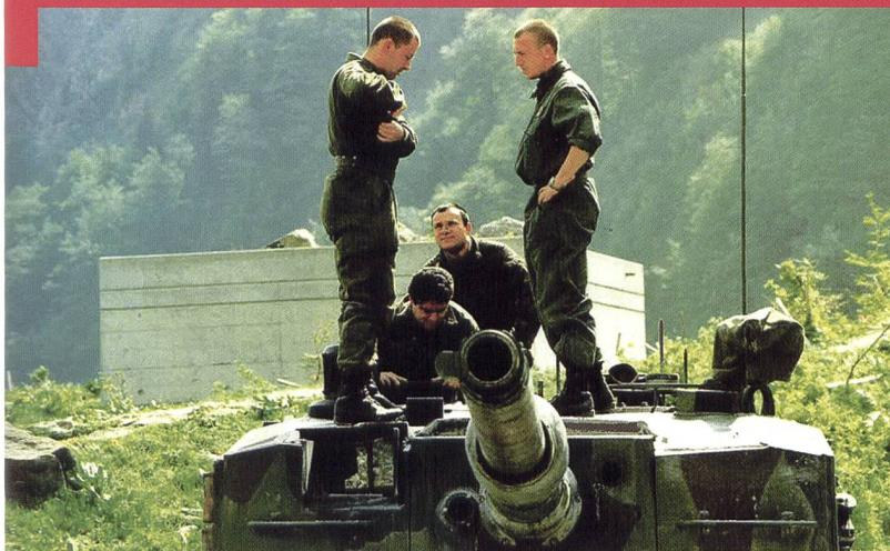
Les cavaliers français découvrent le char Léopard 2 A4 de conception allemande, un char de 3<sup>e</sup> génération capable de tirer en mouvement et armé d'un canon de 120 mm.
