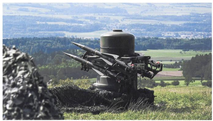
Le missile en lui-même pèse 45 kg et mesure 2,24 mètres de long. Il vole 3'062 km/h (Mach 2,5). Il est capable d'intercepter un appareil volant à une distance de 400 (minimum) jusqu'à 8'200 mètres (maximum) et jusqu'à une altitude de 3'000 mètres. A ces distances, le temps de vol du missile jusqu'à sa cible varie de 6 à 13 secondes seulement.
