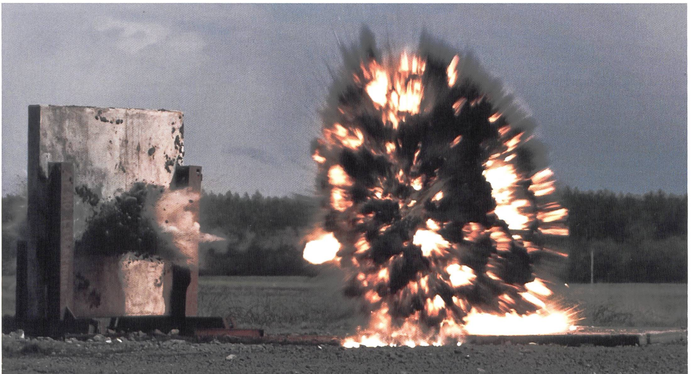
Perforation d'un mur avec détonation successive d'un obus explosif 15.5 cm DM121 de Rheinmetall. Photo © Rheinmetall Waffe Munition GmbH.
