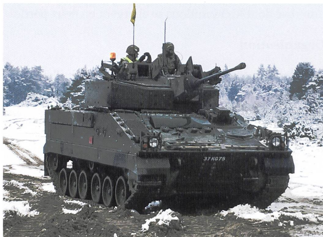
Les illustrations de cette page présentent le programme de revalorisation du véhicule de combat d'infanterie Warrior équipé d'une tourelle de 40 mm CTAI et d'un blindage sensiblement renforcé..
