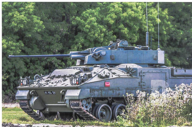
Les illustrations de cette page présentent le programme de revalorisation du véhicule de combat d'infanterie Warrior équipé d'une tourelle de 40 mm CTAI et d'un blindage sensiblement renforcé..
