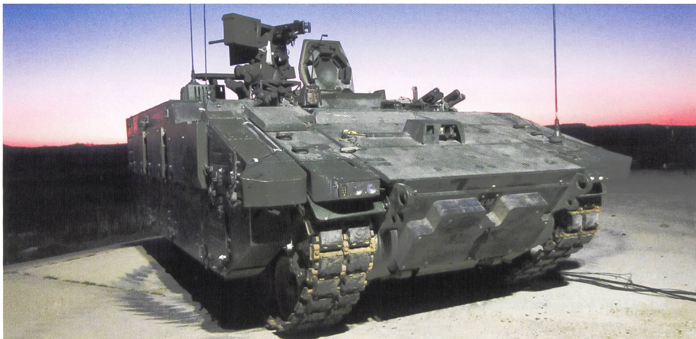
Ci-dessus et ci-dessous : L' Ajax se décline en engins spécialisés ou de transport de troupes, légèrement armé. Au bas de la page : La version de reconnaissance est armée d'une tourelle de 40 mm à munitions télescopées.
