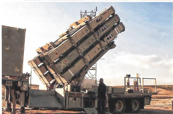
360° et de suivre une centaine de cibles simultanément. Chaque système permet d'engager entre 8 à 10 cibles jusqu'à 20km de hauteur et sur 160km en horizontal. Chacun des trois systèmes peut engager une variété de cibles diverses et de roquettes et de missiles balistiques à trajectoire courbe ou tendue. Chacun offre la possibilité de se connecter en réseau et de communiquer également avec le futur avion de combat.
