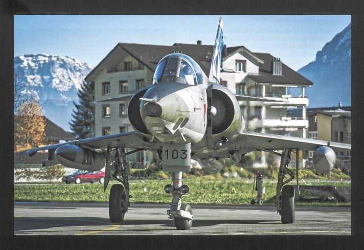
Deux vues de face qui permettent de bien voir les ouvertures frontale/latérales des caméras optiques. Pour les missions de nuit ou par mauvais temps, l'AMIR était en mesure d'employer un nacelle *Red Baron* équipée d'un système de prises de vue infrarouge.
