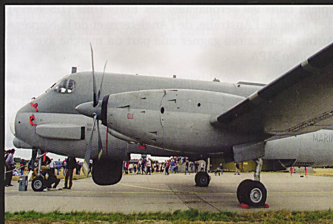
Le Breguet Atlantic de la Bundesmarine et un patrouilleur maritime, destiné à explorer les étendues maritimes pour rechercher, surveiller bâtiments de surface et sous-marins, guider d'autres unités de combat vers un objectif et, éventuellement, le détruire lui-même. Egalement en service, par exemple, dans l'aéronavale française et italienne. Le dernier vol dans la Bundesmarine a eu lieu le 20 juin 2010. Depuis, ces appareils ont été remplacés par des P-3 Orion d'origine néerlandaise. Ces appareils ont été entièrement revalorisés et servent aujourd'hui principalement à l'exploration électronique.
