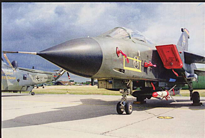
Le scotch et le meilleur ami des mécaniciens et des pilotes – sur le Tornado , mais aussi sur l'Eurofighter Typhoon dernière génération, la fermeture du cockpit n'est pas assurée quand le moteur n'est pas allumé.
