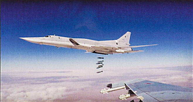
Ci-dessus : Deux vues montrant l'engagement des Tu-22M russes au-dessus de la Syrie. Cet appareil est plus polyvalent que les autres types. Il peut emporter jusqu'à 69 bombes FAB-250 ou 8 bombes FAB-1500. Le dernier chiffre indique le poids de la munition.
