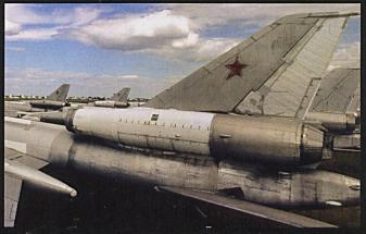
Les plaques blanches indiquent du materiel confronté aux hautes températures pendant le vol supersonique. Cette machine porte l'aigle du 121 TBAP à Machulishchi (aujourd'hui en Biélorussie). On note les différents systèmes ECM/Radar sur l'empennage. Quelques exemplaires ont même reçu un canon téleguidé de 23mm.
