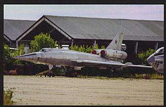
Le Tu-22LL est une version utilisée pour les essais de systèmes ECM (contre mesures électroniques). Ici muni d'un nez modifié à des fins de tests de diminutions de bruits aérodynamiques.
