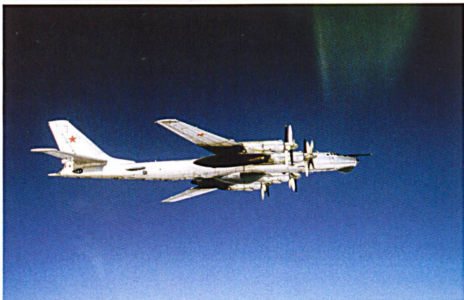
Le Tupolev 142, reconnaissable notamment à son nez vitré, porte un puissant radar sous le ventre. Il s'agit de la version de surveillance et d'attaque navale du Bear . Il n'est pas considéré comme un bombardier stratégique au sens des traités internationaux.
