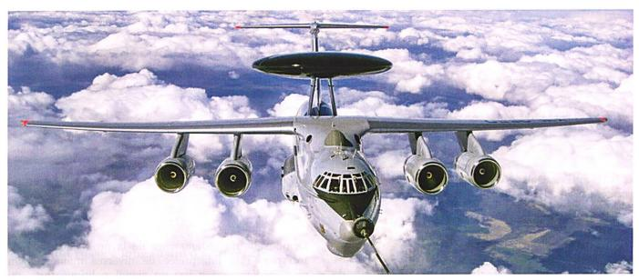
Ci-dessus et à droite: Ravitaillement en vol d'un avion d'alerte avancée et de commandement Beriev A-50. La cellule de cet appareil, comme celui de son ravitailleur, est basée sur l'avion de transport llyushin II-76 *Mainstay*.
