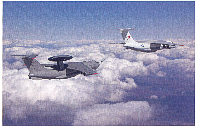
Ci-dessus et à droite: Ravitaillement en vol d'un avion d'alerte avancée et de commandement Beriev A-50. La cellule de cet appareil, comme celui de son ravitailleur, est basée sur l'avion de transport Ilyushin Il-76 Mainstay .
