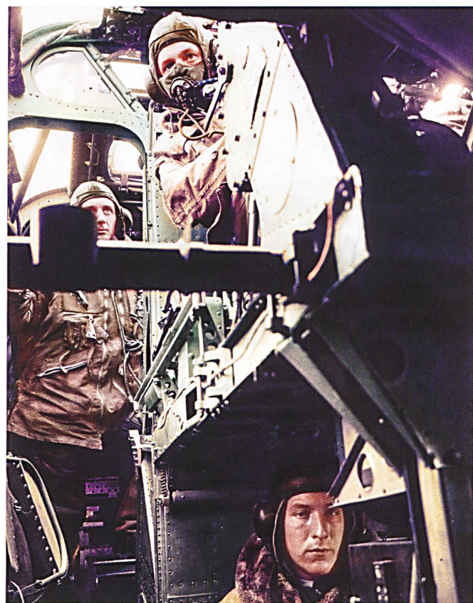
Le compartiment de l'équipage d'un Handley Page Halifax (No. 35 Squadron, RAF) consiste en un étage supérieur qui accueille les deux pilotes et l'ingénieur de vol. Un étage inférieur accueille l'opérateur radio, l'observateur / navigateur et le bombardier. © IWM.
