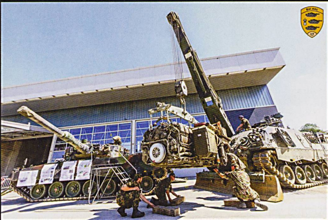
Un char de dépannage Büffel vient de démonter le « powerpack » de 1'500 chevaux du char à côté de lui. Photo © Neo-Falcon.
