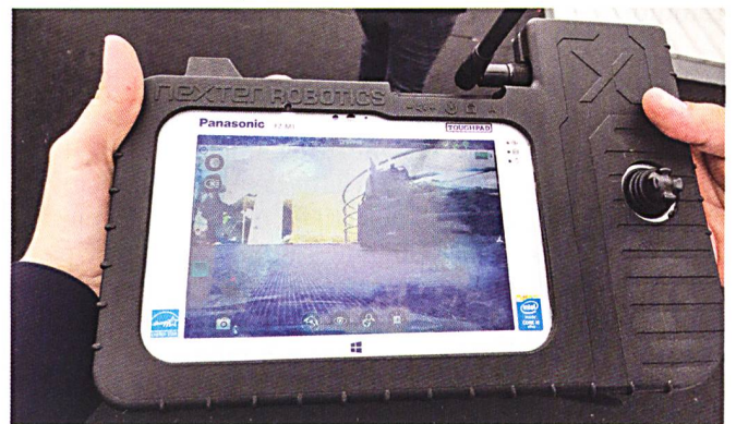
La tablette et les commandes à distance permettent à un combattant débarqué de piloter le système à distance.
