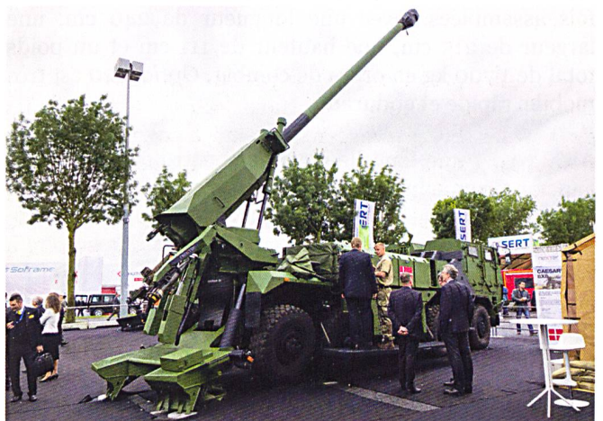
Ces deux illustrations présentent l'évolution du système, à partir d'un châssis 6x6 léger et aérotransportable, vers un châssis 8x8 plus résilient et plus autonome. Photos © A+V.
