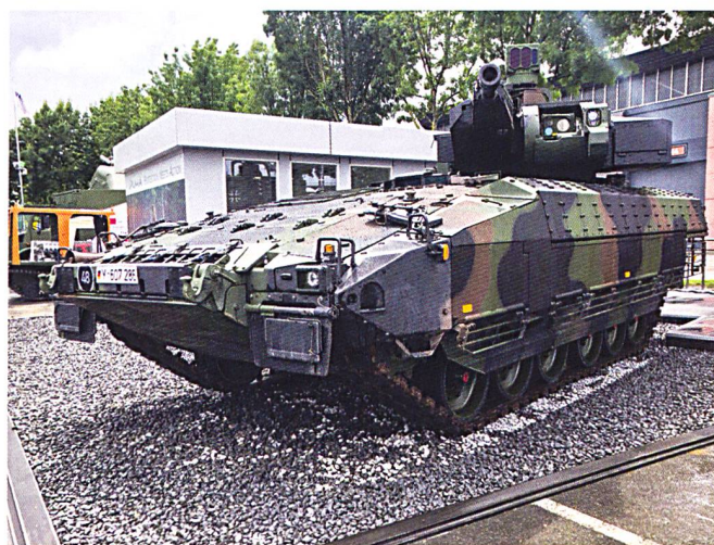
Le Puma actuel, dit de 2 e génération, dispose d'un périscope panoramique au sommet de la tourelle et de capteurs améliorés. Celui-ci était présenté à Eurosatory 2018. Photo © Auteur.
