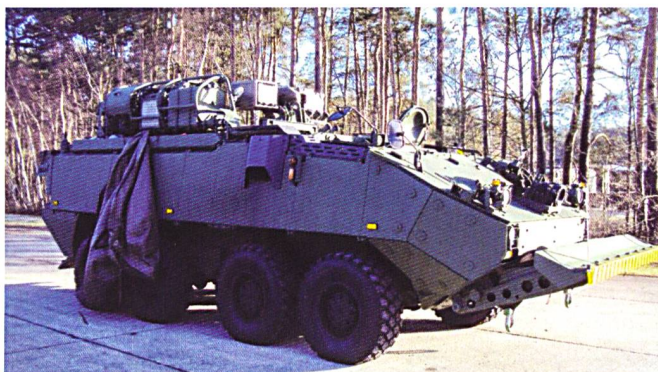
Ci-dessous : La version de dépannage (Recovery) est dotée d'une lame ainsi que d'un atelier diagnostique et réparation mobile.
