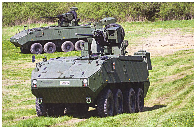
Le DF30 est un engin de combat d'infanterie, équipé d'une tourelle d'origine israélienne armée d'un canon automatique de 30 mm.
