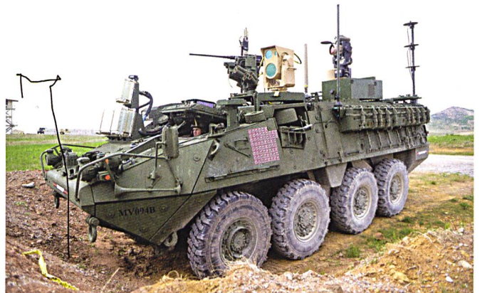
Deux vues du Dragoon – un véhicule de combat d'infanterie doté d'une tourelle armée du canon automatique de 30 mm MK 44 Bushmaster II . Cette même arme est montée sur la famille M2/M3 Bradley . Le troisième est un engin de reconnaissance M1127.
