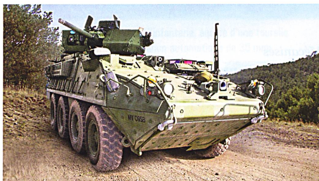
Deux vues du Dragoon – un véhicule de combat d'infanterie doté d'une tourelle armée du canon automatique de 30 mm MK 44 Bushmaster II . Cette même arme est montée sur la famille M2/M3 Bradley . Le troisième est un engin de reconnaissance M1127.
