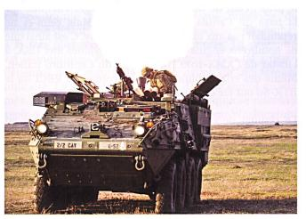
kit de protection supplémentaire; il est capable de résister un certain temps à des projectiles de 14,5 mm. Son canon M68 de 10,5 cm est le même que l'ancienne génération des chars M-60, mais il est entièrement stabilisé et dispose d'un rechargement automatique. La tourelle est d'ailleurs entièrement automatisée: l'équipage reste dans la carcasse.
