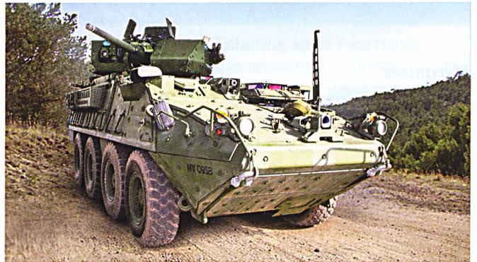
Deux vues du Dragoon – un véhicule de combat d'infanterie doté d'une tourelle armée du canon automatique de 30 mm MK 44 Bushmaster II . Cette même arme est montée sur la famille M2/M3 Bradley . Le troisième est un engin de reconnaissance M1127.
