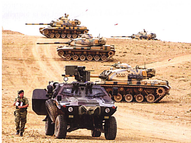
Chars turcs M-60 A3 armés du canon d'origine de 10,5 cm rayé M68. Ces engins sont conformes à la configuration de l'USAREUR des années 1980. Le canon d'origine est le L7 de 10,5 cm L52- une arme développée par les ateliers britanniques de la Royal Ordnance.
