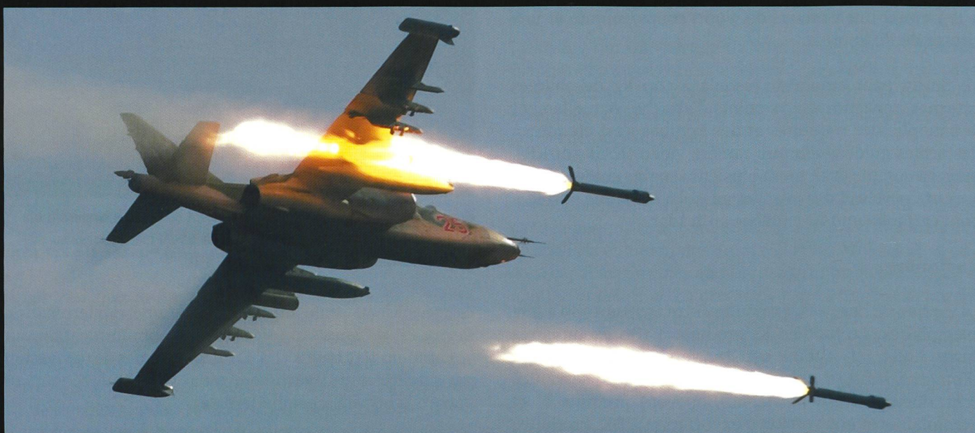
L'arme principale du Frogfoot consiste en des roquettes non-guidées de différents calibres.
