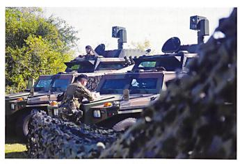
De haut en bas: Véhicules commandant de tir *Eagle* équipés d'optiques et de systèmes de transmission de données pour la désignation des buts et la conduite du feu. Le M113 est encore en dotation dans l'infanterie, notamment pour équiper les postes centraux de tir et les commandants de batterie. L'obusier blindé M109, ici sur le col du Simplon, est le principal moyen d'appui de feu des formations de combat. Toutes les photos © Gr art 54.
