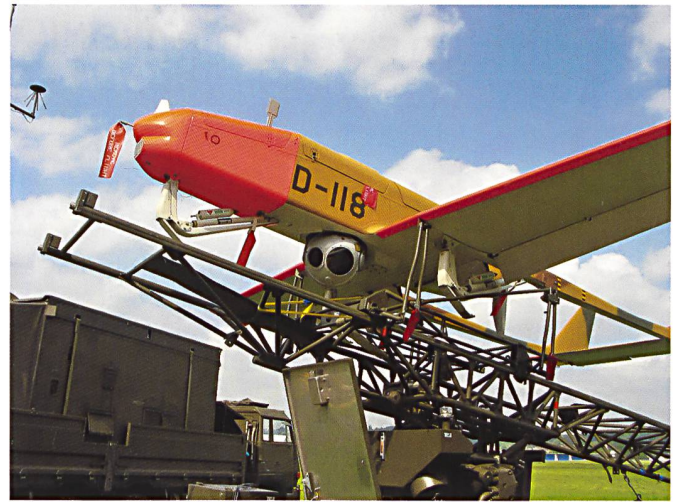
L'ADS95 est catapulté à partir d'un véhicule de transport.
