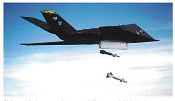
Ci-dessus: Le lancement des armes s'effectue par le biais de deux éjecteurs surnommés « trapèzes. » La soute à bombes ne reste ouverte que quelques secondes.
