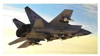
Ci-dessus: L'armement classique du MiG-31 se compose de quatre missiles à longue portée AA-9 et de deux missiles à courte portée AA-11. Le canon GSh-6-23 est visible à droite du fuselage. Ci-dessous: Une ligne de vol sur l'aérodrome de Khotilovo.
