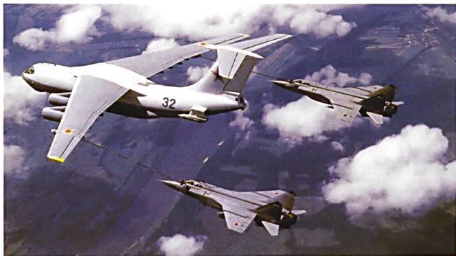
Comme son prédécesseur le MiG-25, le MiG-31 est destiné à l'interception à longue portée. Pour ceci, il dispose d'un radar performant et de transmissions de données radar et tactiques au sein du groupe et avec les radars aériens (A-50) ou terrestres. Contrairement à son ancêtre, il peut être ravitaillé en vol par l'I-76 ci-dessus.
