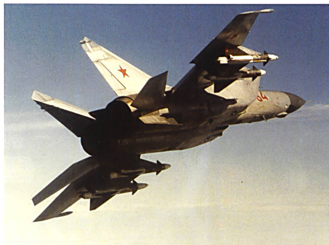
Ci-dessus : La version de reconnaissance du MiG-25RB, aux couleurs de la 2 e escadrille du 47 e régiment de reconnaissance de la Garde (GvORAP). Cette version pouvait emporter des bombes, qui auraient pu être larguées à haute altitude, à une distance de près de 40 km de leur cible. Ainsi larguées, ces dernières auraient été supersoniques en touchant le sol et auraient pu pénétrer 30-40 mètres de terre.
