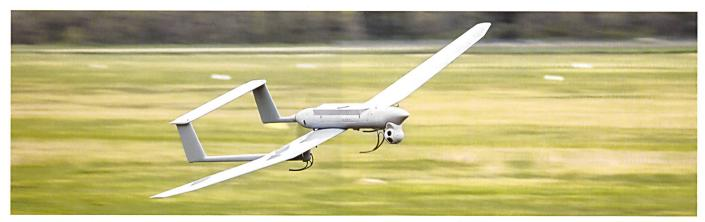
Le DVF-2000 à propulsion électrique de Survey Copter, filaile d'Airbus Defence & Space, testé par la MArine française. Lancé par catapulte, il est récupéré dans un filet.
