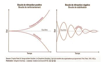
Représentation visuelle des deux types de boucles de rétroaction : Positive à droite, négative à gauche (respectivement de renforcement et de stabilisation).
