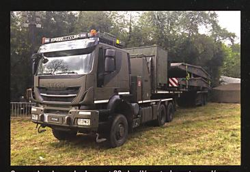
Comme dans le cas du char pont 68, des éléments de ponts supplémentaires peuvent être acheminés par camion. Ci-dessous: A Full, de nombreux prototypes de la société Mowag sont exposés en sous-sol.
