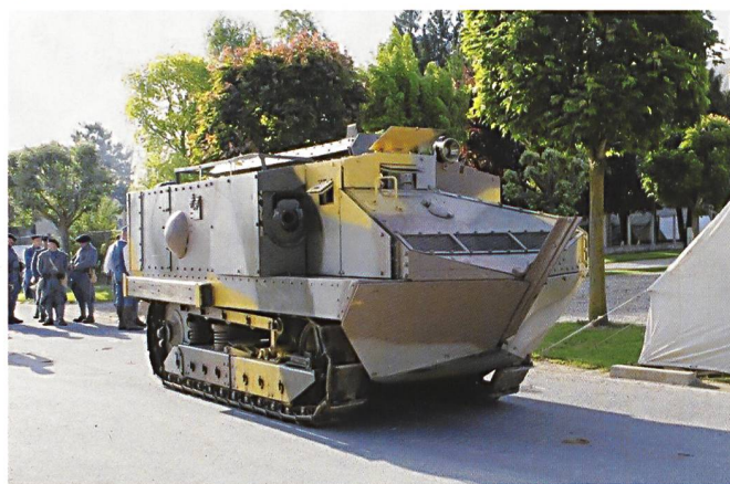
Le char Schneider CA1 pèse 13,6 tonnes et emporte une arme de 75 mm à canon court, ainsi que deux mitrailleuses
