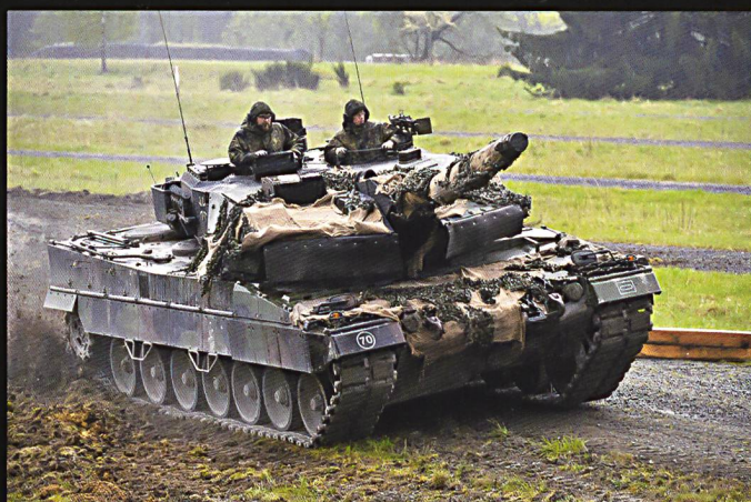
Le Léopard 2A6 allemand pèse aujourd'hui près de 70 tonnes. Celui-ci n'est pas amunitionné car il ne porte aucun drapeau et la coiffe de bouche à feu est encore montée.
