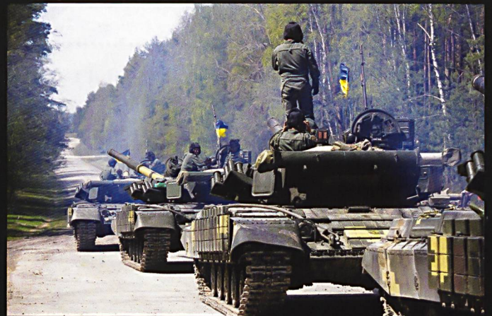
Une section de T64 ukrainiens prête à rouler. On remarque sur les flancs les caissons de munitions pour la mitrailleuse de 12,7 mm, les lance-pots nébuleux et les briques de blindages réactifs (ERA).
