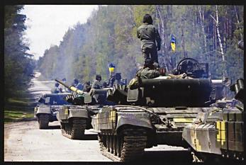
Une section de T64 ukrainiens prête à rouler. On remarque sur les flancs les caissons de munitions pour la mitrailleuse de 12,7 mm, les lance-pots nébulogènes et les briques de blindages réactifs (ERA).
