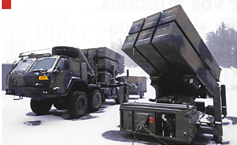
Le système NASAMS, pour « Norwegian Advanced SAM System. » Chaque système contient 6 missiles AIM-120 AMRAAM de fabrication américaine. Le missiles portent la dénomination « SL-AMRAAM, » de l'anglais : *Surface-Launched AMRAAM*.
