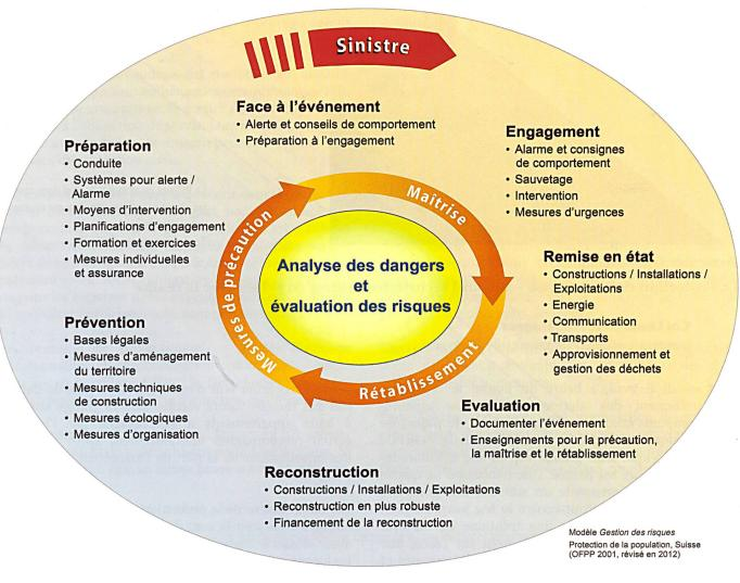
Le cycle de la gestion intégrale des risques est à la base d'une approche systématique des risques à l'aide de mesures équilibrées de précaution, maîtrise et rétablissement en cas de catastrophe et de situation d'urgence.
