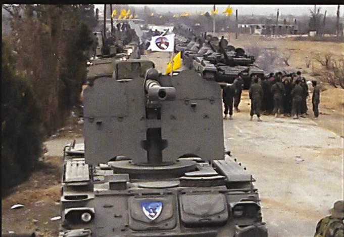
Au premier plan : KS-1 sur châssis GM-578. A gauche : colonne de M113A1, à droite, deux T-72 (AV suivi d'un M1), et T-62.
