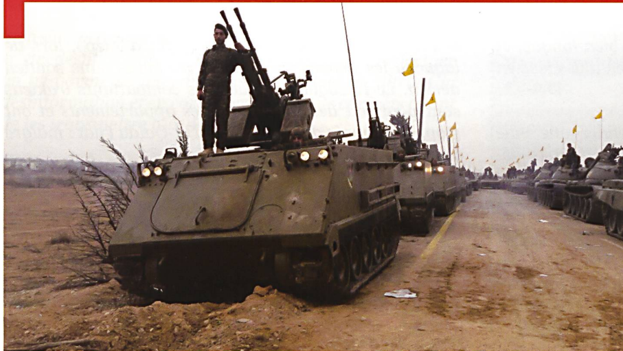
Une colonne de véhicules du Hezbollah à al-Qusayr, le 13 novembre 2016. A gauche : des transporteurs de troupe M113A1, équipés d'un canon anti-aérien bitube ZPU-2. A droite : des T-54A et T-62 .obr 1972.
