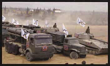
Quatre tubes de 302 mm sur châssis de camion, 2 copies de BM-21 à 50 tubes, deux 2S1 *Gvozdika*.
