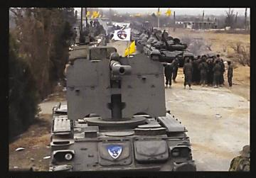
Au premier plan : KS-1 sur châssis GM-578. A gauche : colonne de M113A1, à droite, deux T-72 (AV suivi d'un M1), et T-62.
