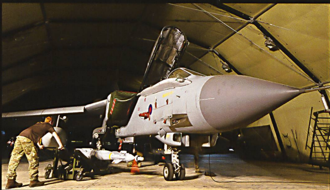
Ci-dessous : Armement d'un autre appareil de bombes à guidage laser Paveway IV . La désignation des buts se fait au moyen d'une nacelle Lantirn , également emportée par le Tornado .
