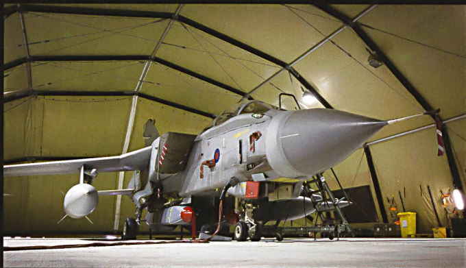
Ci-dessus : Un Tornado est armé de missiles de croisière Storm Shadow , d'un poids de 1'300 kg et d'une portée supérieure à 250 km.
