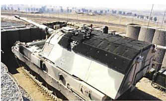
Ci-dessus: Le Panzerhaubitze 2000 emporte un tube de 52 calibres, sur le châssis du char  $L\'{e}opard$  2.
