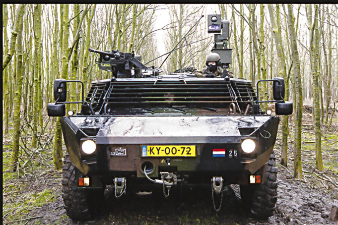
Les unités d'exploration disposent du Fenneck - un engin 4x4 construit par Krauss Maffei Wegmann (KMW). Les engins de combat principaux sont des CV90 néerlandais et des Léopard 2A7 allemands.
