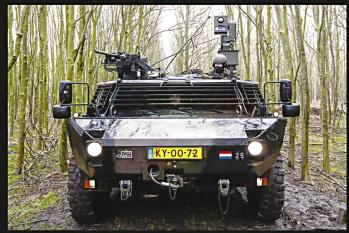
Les unités d'exploration disposent du Fenneck - un engin 4x4 construit par Krauss Maffei Wegmann (KMW). Les engins de combat principaux sont des CV90 néerlandais et des L'eopard 2A7 allemands.
