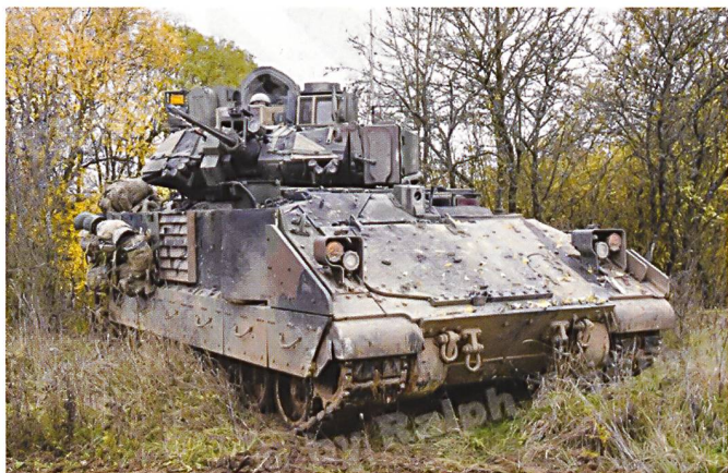
Le M3A2 est la version de reconnaissance du Bradley . Il dispose du même armement que le M2 de l'infanterie, mais emporte davantage de munitions et seulement deux explorateurs à l'arrière.
