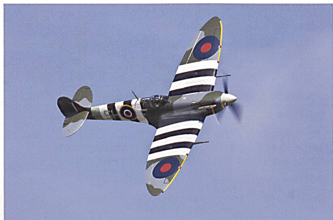
Ci-dessous : Un Spitfire Mk. Vb dont l'aile emporte deux canons de 20 mm et quatre mitrailleuses de 7,7 mm.
