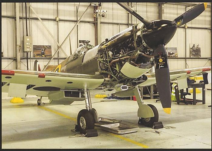
Ci-dessus : Entretien périodique d'un *Spitfire* Mk. Il du BBMF. Ci-dessous : Maintenance d'un *Spitfire* Mk. IX et de son moteur *Merlin* dans le désert.
