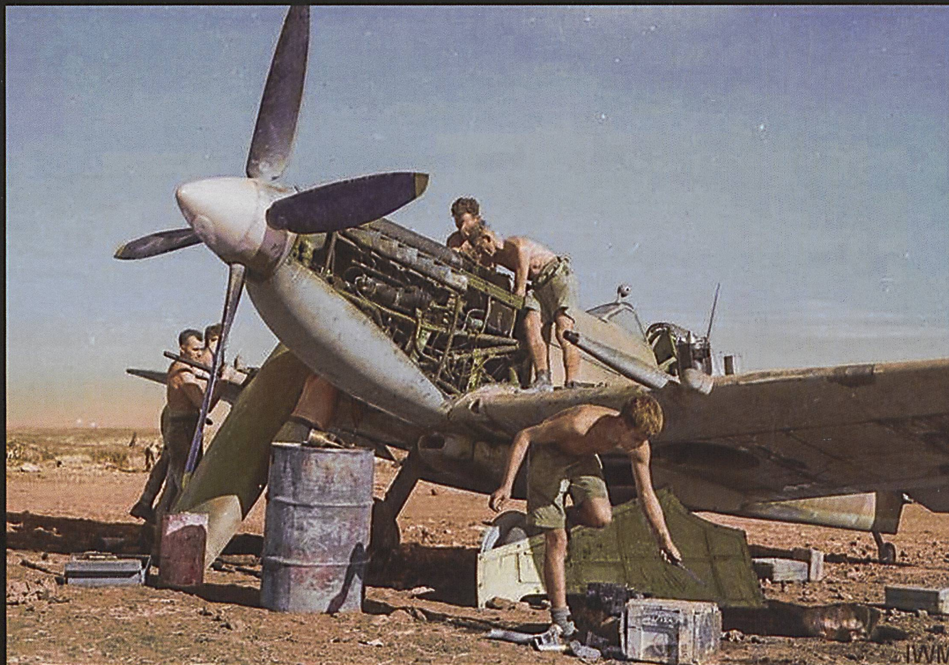
Ci-dessous : Maintenance d'un Spitfire Mk. IX et de son moteur Merlin dans le désert.
