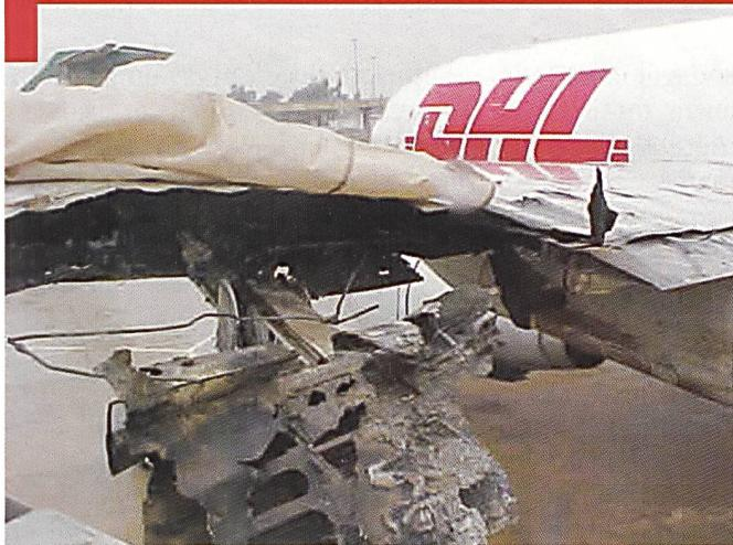
Un exemple des dégâts que peut engendrer un MANPADS sur avion civil.
