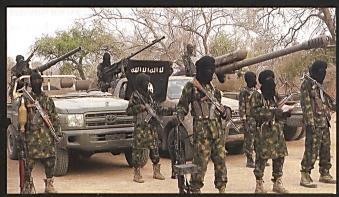
Une section de « parade » de Boko Haram à l'occasion d'un message vidéo. Notez à gauche le canon 2A28 Grom de 73 mm ( cannibalisé d'un BMP-1) monté sur un pickup.
