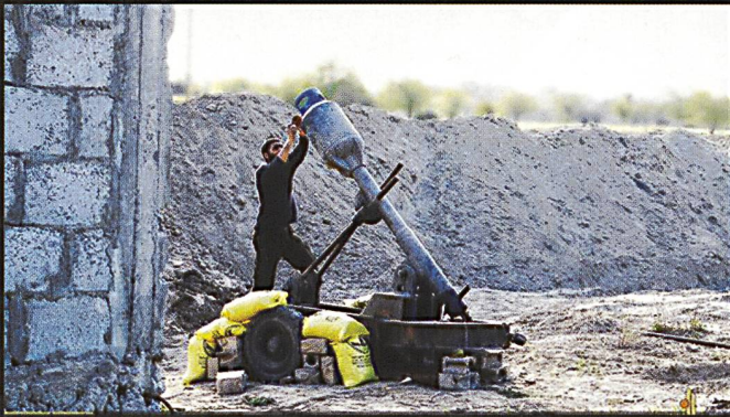
Un servent charge un « Hell Cannon » avec une bouteille de gaz. Notez comment l'extrémité supérieure de la bouteille, qui contient le détonateur, sort du « canon. »
