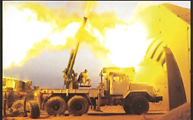
Tir d'un D-30 (122 mm) sur plat-forme mobile, en faisant un canon automoteur. Le D-30 est utilisé soit comme artillerie de longue portée, soit comme canon antiaérien.
