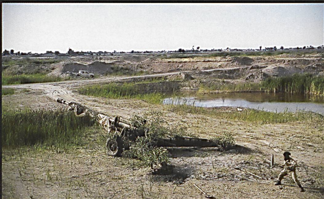
Ci-dessus : Un canon antimatériel artisanal de 23 mm. Notez les trois chambres de bouche du tube pour limiter le recul. Le canon est équipé d'une lunette de SVD Dragunov .
