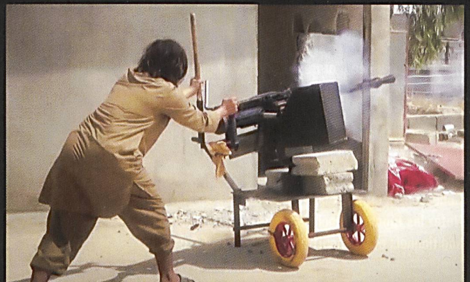
Ci-dessus : Tir d'une KPV 14.5 mm sur une « brouette » de combat. Très efficace à courte distance, ce système n'est pas précis à longue distance et n'offre pas de protection à son tireur.
