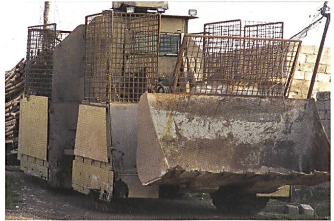
Un bulldozer renforcé de plaques de blindage et adjoint d'une structure cage contre les roquettes.
