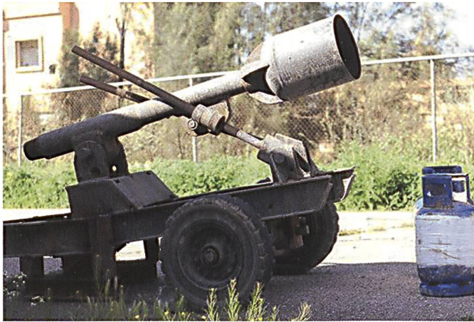
Un « Hell Cannon » en position de charge. Le projectile, une bouteille de gaz, est remplie d'explosif et de shrapnel.
