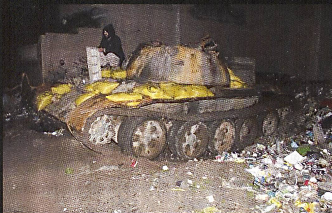
Un T-54/55 défectueux (privé de son canon) reconverti en SVVIED. Notez les sacs de sable pour une protection additionnelle.
