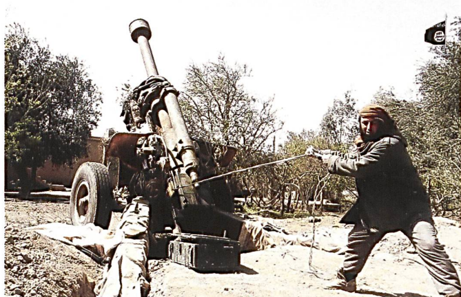
Un rare M-46 de 130 mm employé en tire courbe. Notez le raccourcissement artisanal du canon
