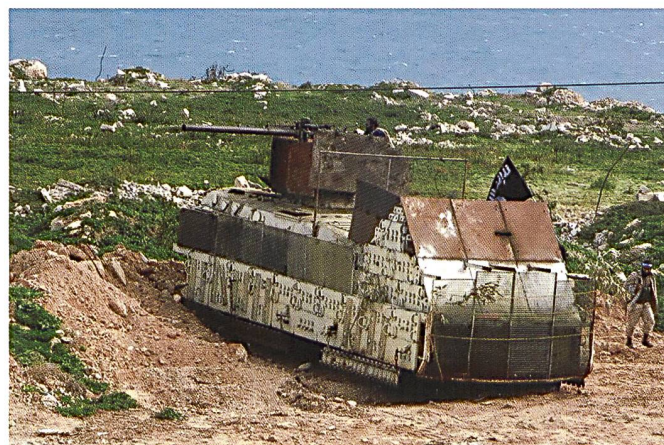
Un « bus de bataille », avec une tourelle équipée d'un lance-roquette sans recul.
