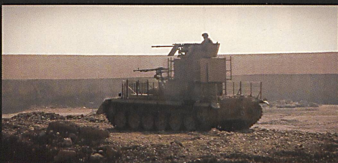
Ci-dessous : Un « bus de bataille » sur châssis de T-72. Le char dispose d'un superstructure additionnelle à deux étages, dont une mobile (DSHK et ZPU-2) et d'un blindage cage.
