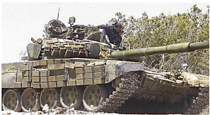
Le T72AV ci-dessus est équipé de blindages réactifs (ERA). Celui d'en bas a reçu des grillages ad hoc sur les flancs de tourelle. Ci-dessous, à gauche : Un châssis T55 a été équipé d'un affût de canon anti-aérien de 50 mm.
