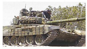
Le T72AV ci-dessus est équipé de blindages réactifs (ERA). Celui d'en bas a reçu des grillages ad hoc sur les flancs de tourelle. Ci-dessous, à gauche: Un châssis e T55 a été équipé d'un affût de canon anti-aérien de 50 mm.
