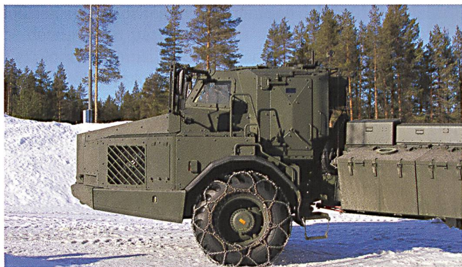
Cabine blindée et pressurisée de l'ARCHER.
