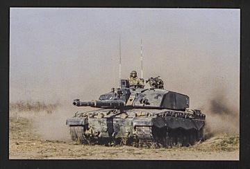
Ci-dessus: Le *Sceptre* est la version revalorisée du *Scimitar*. Il sert d'engin de reconnaissance dans les groupements de combat mécanisés. A droite et ci-dessous : Le char *Challenger* 2 se distingue de son prédecesseur par un dispositif de visée monté sur le bouclier du canon ; mais également par le fait qu'un grand nombre des composants du châssis et du train de roulement sont issus du *Léopard* 2 allemand.
