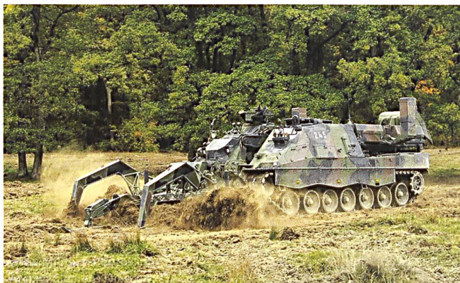
Le char du génie Kodiak , engagé au sein du Pz Sap Bat 11, peut être configuré pour des travaux de terrassement (en haut) ou de déminage (en bas). Voir article p. 39.
