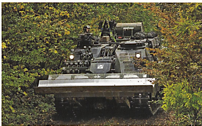
Le char du génie Kodiak , engagé au sein du Pz Sap Bat 11, peut être configuré pour des travaux de terrassement (en haut) ou de déminage (en bas). Voir article p. 39.
