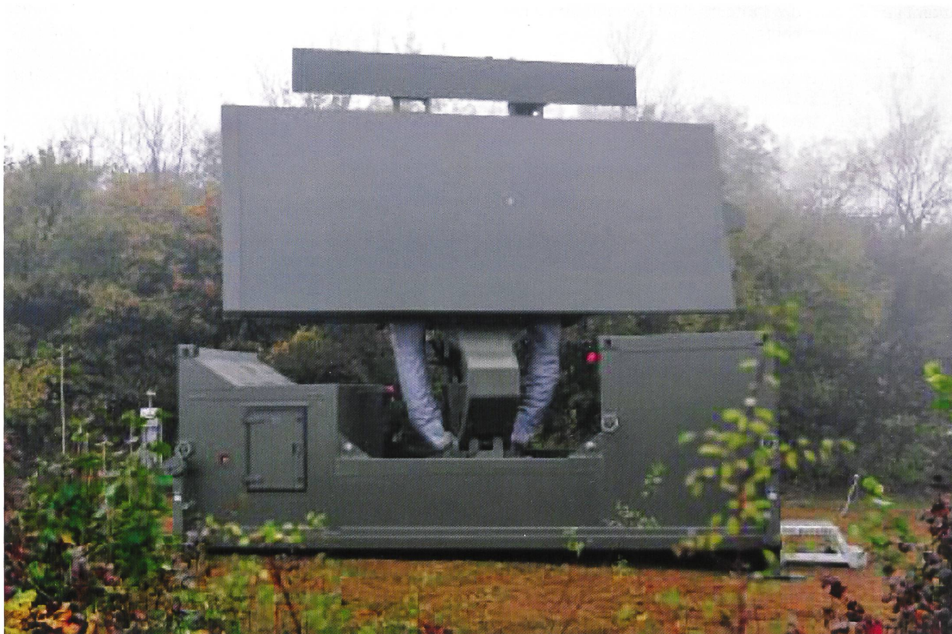
Radar de surveillance aérienne GM400.
