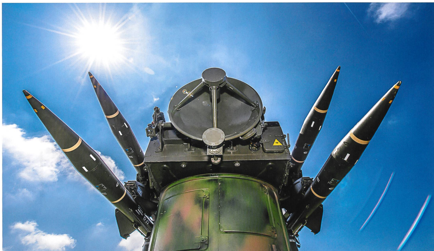
Quatre engins guidés par lanceur représentent la puissance de feu d'une unité de feu Rapier .
