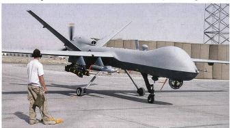
Le premier drone armé a été le MQ-1 *Predator*. L'engin pèse 512 kg à vide et peut emporter environ 500 kg. Il vole à 130-165 km/h durant 24 heures - soit une autonomie de 1'100 km.
