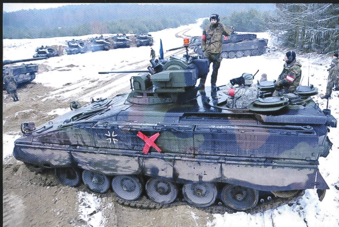
Les versions surblindées du Marder atteignent 33,5 tonnes (A3) et jusqu'à 37,4 tonnes pour les quelques exemplaires déployés en Afghanistan (A5).
