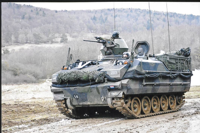
Les Pays-Bas a liquidé la plupart de leurs YPR-765, sur châssis de M113 renforcé.
