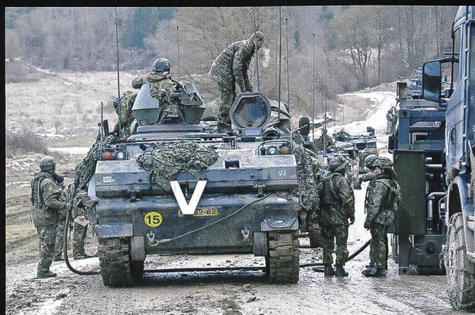
Les Néerlandais disposent de citernes capables de ravitailler deux véhicules simultanément.
