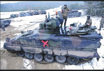
Les versions surblindées du *Marder* atteignent 33,5 tonnes (A3) et jusqu'à 37,4 tonnes pour les quelques exemplaires déployés en Afghanistan (A5).
