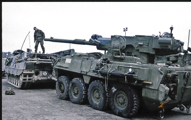
Un Mobile Gun System (MGS) M1128 est remorqué par un Büffel néerlandais.
