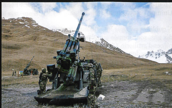
Plus de 77 Césars sont en service au sein de l'armée française. Le système pèse 19 tonnes et est monté sur un châssis Unimog qui confère un certain degré de protection à l'équipe durant les déplacements.
