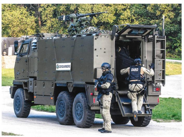
Ci-dessus : Des membres du DARD sont amenés à pied d'oeuvre et en toute sécurité dans un GMTF. La protection balistique de ce véhicule est supérieure au char de grenadiers à roues 93 *Piranha*.
